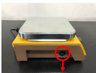
①开启系统总电源开关
