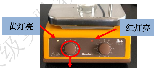
②旋转磁力搅拌马达控制旋钮，调节转速
